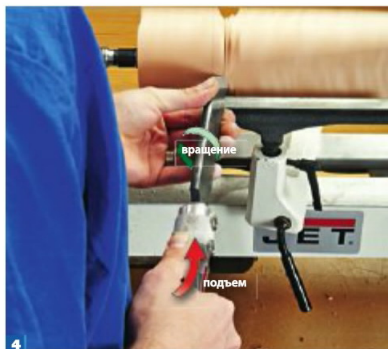
4 Легкими движениями, срезая материал понемногу, сформируйте закругление, начинающееся у верхней метки и заканчивающееся полной окружностью внизу.
