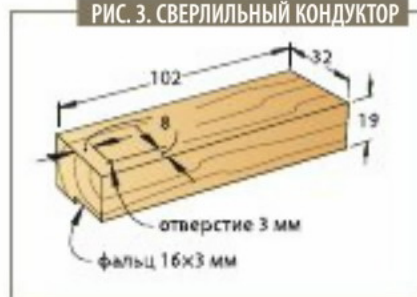
РИС. 3. СВЕРЛИЛЬНЫЙ КОНДУКТОР
