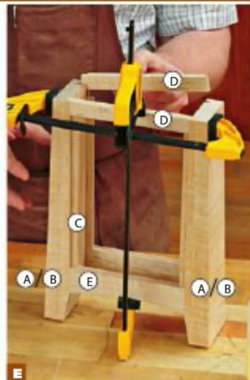
E Наконец, когда клей схватится, приклейте на место верхние перекладины D, фиксируя корпус струбцинами по вертикали и с боков.
