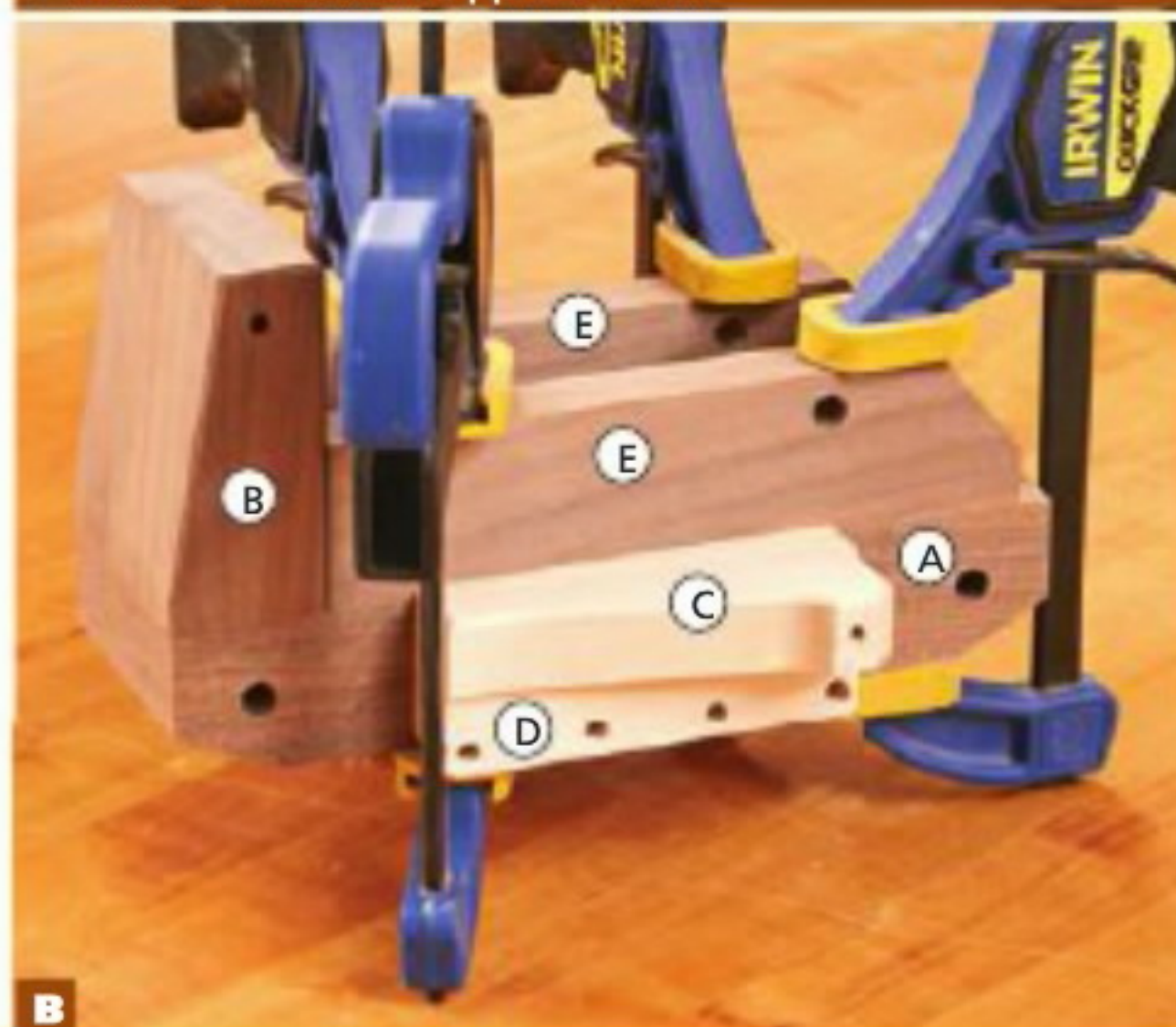
В Приклейте боковины Е вплотную к задней стороне радиатора В вровень с внешними краями шасси А.
