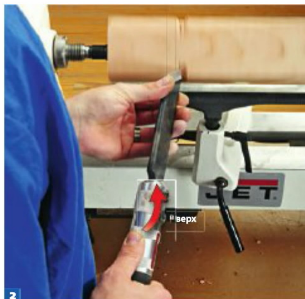
2 Сделайте несколько углубляющихся резов, с каждым разом передвигая резец ближе к нижней границе перехода.
