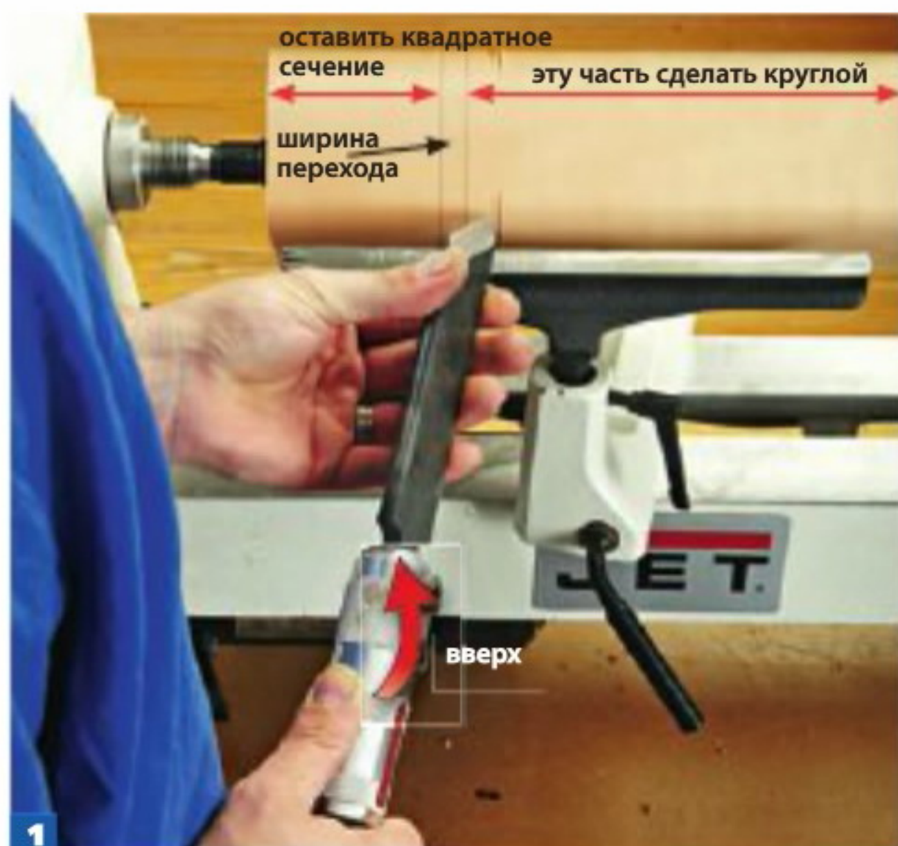
1 Направьте кончик резца-мейселя вниз и слегка коснитесь режущей кромкой заготовки, отступив около 12 мм правее нижней метки, и сделайте надрез глубиной 2 мм.
