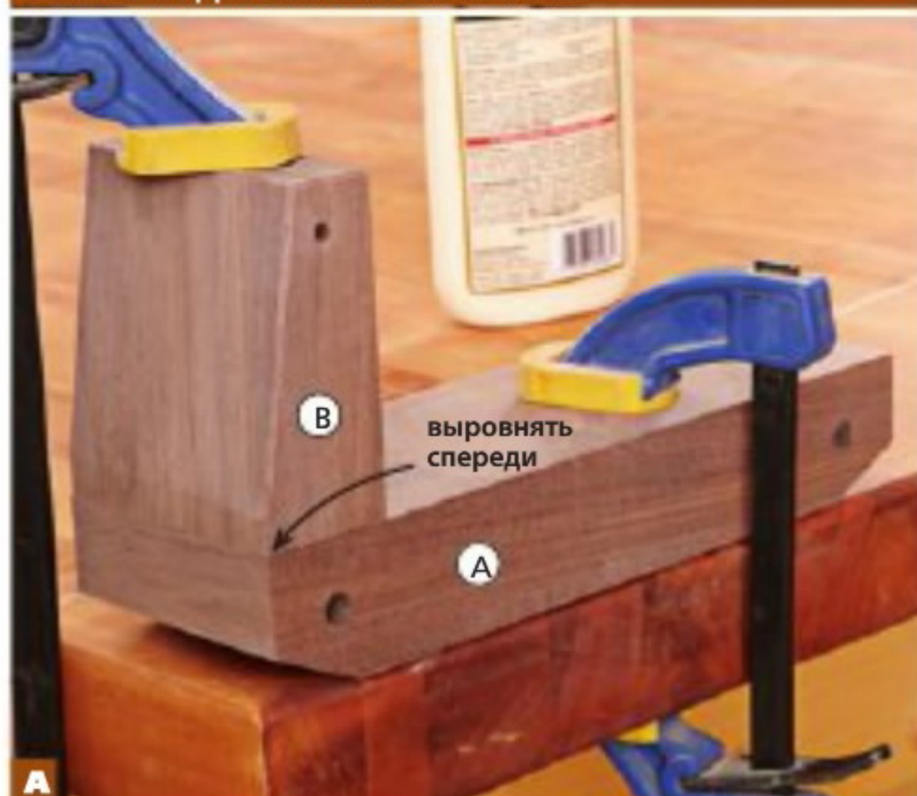
А Зафиксируйте шасси А струбциной на верстаке, чтобы деталь не качалась. Приклейте радиатор В и прижмите его струбциной.
