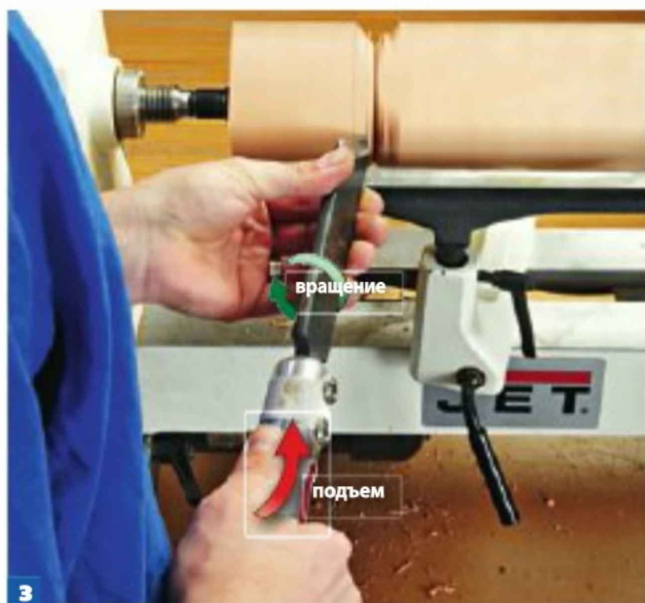
3 Дойдя до нижней отметки, начинайте вращать резец по часовой стрелке на 90°.
