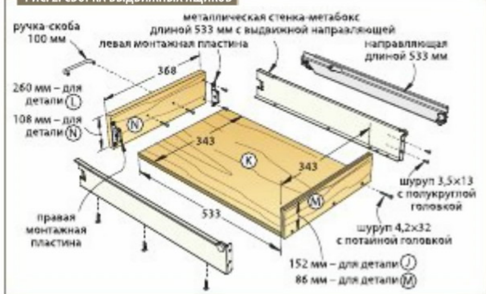
РИС. 2. СБОРКА ВЫДВИЖНЫХ ЯЩИКОВ
